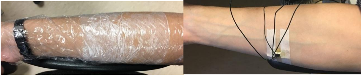
Joonis 4. Veekompressi rakendamine ja elektroodide paigutus paremale küünarvarrele peale veekompressi eemaldamist eesmärgiga mõõte impedantsi
