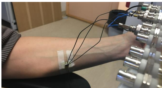
Joonis 3. Elektroodide asetamine nahale ja kinnitamine teibiga enne vee- ja mudakompressi rakendamist vasakule küünarvarrele eesmärgiga mõõta impedantsi
